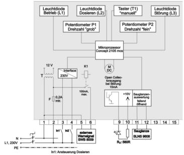
In2: ext. Störung zum Durchschleifen bei Anreihbetrieb mehrerer Pumpen
