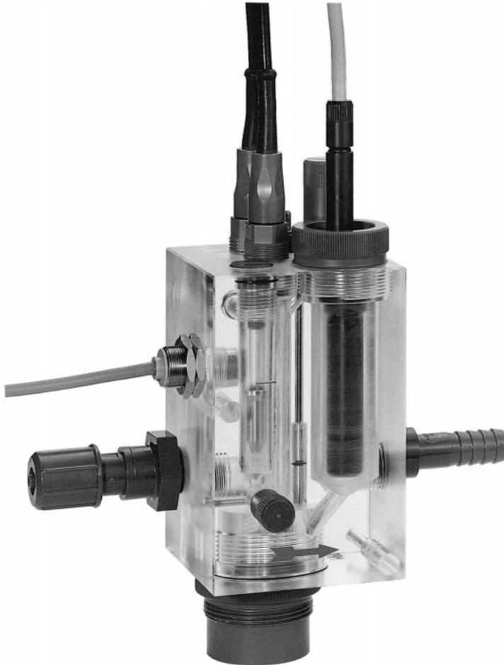
Die Durchflußarmatur OCA 250 wird speziell zur Aufnahme der Chlorsensoren OCS 140 / OCS 141 bzw. der Chlordioxidsensoren OCS 240 / OCS 241 verwendet. Zusätzlich sind zwei Einbauplätze zur Aufnahme einer Redox- und einer pH-Einstabmeßkette (z.B. Typ OPS 32-0 FBO-2 GSA und OPS 31-1 ABO-2 GSA) vorgesehen.
