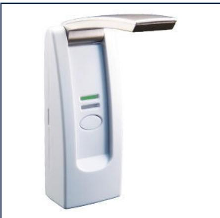
Die grüne LED blinkt einmal, wenn der Router ausgeschaltet ist bzw. wenn das LAN-Kabel nicht angeschlossen ist.
