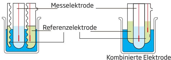
Heutzutage werden auch kombinierte Elektroden mit integriertem Temperatursensor angeboten. Diese erleichtern das Handling, ermöglichen die gleichzeitige Messung von pH und Temperatur sowie eine automatische Temperaturkompensation der pH-Messwerte.
