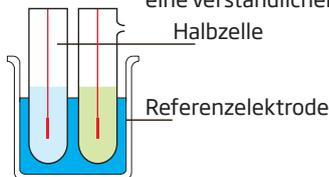
Ende der 40er Jahre wurde die erste kombinierte pH-Elektrode hergestellt. Bei kombinierten Elektroden sind Mess- und Referenzelektrode in einem Gehäuse vereint. Sie sind handlich und garantieren, dass die Temperatur beider Elektroden während einer Messung gleich ist.
